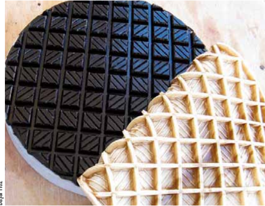
Fotoğraf 1: RTV silikon kalıp kullanılarak yapılan bir cilalama lapı
